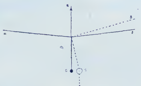
L'inerziale e l'ammortizzamento aerodinamico delle ali s'oppongono al movimento pendolare
